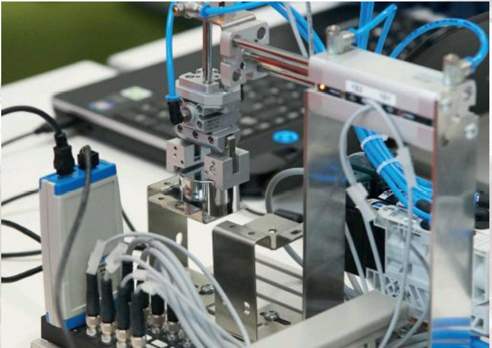
Bestückungsautomat, selbst gebaut und programmiert
